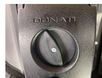
Réglage semi automatique de la tension.
